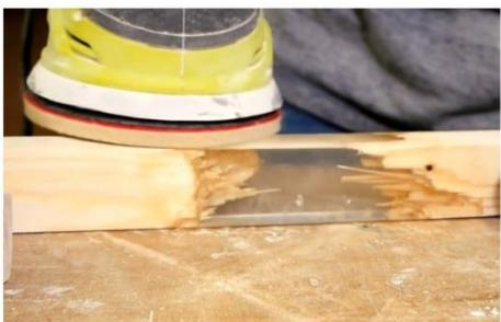
Такие же действия производятся с верхней платформой. Выполняя подобную работу, не стоит забывать о средствах индивидуальной защиты. Пыль от обрабатываемой эпоксидной смолы очень вредна для дыхательных путей и глаз. Поэтому использование респиратора и защитных очков при шлифовании и последующей полировке обязательно. Конечно, если мастер хоть немного дорожит своим здоровьем.
