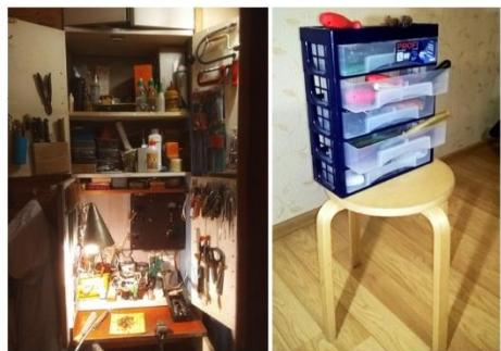
Если рабочее место встроено в **шкаф**, то на распашных дверцах можно на держателях разместить инструменты. Всё находится перед глазами и на расстоянии вытянутой руки. Поработал, дверцы закрыл, столешницу задвинул и ушёл. Никому ничего не мешает. А вот рабочее
