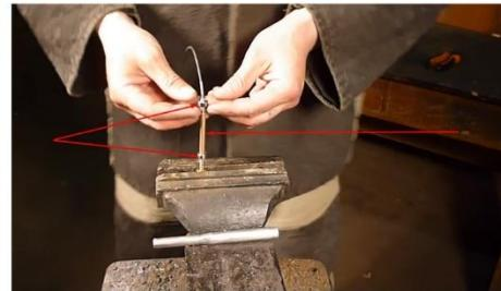
Далее, отрезок трубки, отпиленный от пистолета для монтажной пены, одевается поверх обоих подшипников. По сути, сам механизм вращения на этом можно считать законченным. Останется лишь защитить оператора. Трубка надевается поверх подшипников практически вплотную к наконечнику.
