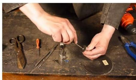
Зажав отрезную фрезу в **дрель**, её центруют при помощи точильного камня.
