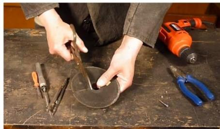
В отверстие вставляется тонкий длинный винт, который с обратной стороны фиксируется двумя гайками.
