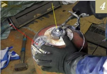
Остаётся приварить петли, чтобы дверца могла открываться. Сама запирающая ручка изготовлена из короткого болта, который вкручен на место крана и приваренной к нему шпильки.
