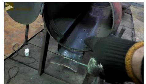
После того, как всё готово, можно установить буржуйку на место, где она будет впоследствии стоять, предварительно сварив верхний и нижний отсек между собой.
