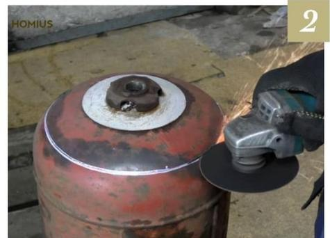
Резка баллона при помощи болгарки по отмеченной линии. После того, как эта работа выполнена, отделённая крышка снимается, а вода переливается во второй баллон. На тех участках, где будут петли нашей будущей дверцы буржуйки, счищается краска с поверхности. Второй газовый баллон готовится к основной работе совершенно идентично.
