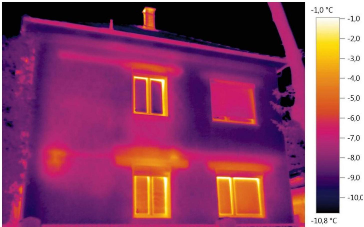
Термограмма — это своеобразный отчет от тепловизора, на котором можно температуру определенных зон в зависимости от его цвета.
