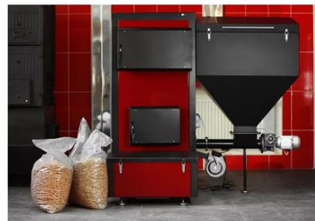
Гранулы разжигаются на электрических ТЭНах, а подача воздуха производится при помощи вентилятора. Когда котлы входят в рабочий режим, электрическая цепь отключается, таким образом, потребление электроэнергии минимально.
